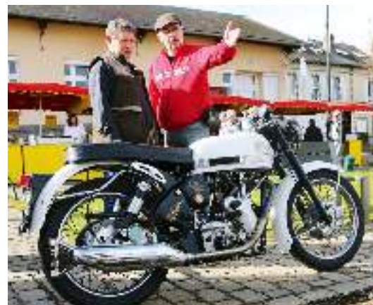
◀ Quoi de plus désirable pour un amateur de gros mono qu'une Panther (alias Phelon & Moore) sloper ? Notez que le moteur très incliné sert comme élément porteur en remplaçant le tube avant du cadre. En 1959 le Model-100 (600 cm 3 ) se double d'un Model-120 (650 cm 3 ) à la course encore plus longue (106 mm). Il sera produit jusqu'en 1966.
