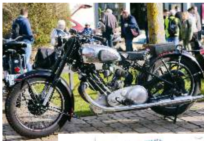
◀ Quoi de plus désirable pour un amateur de gros mono qu'une Panther (alias Phelon & Moore) sloper ? Notez que le moteur très incliné sert comme élément porteur en remplaçant le tube avant du cadre. En 1959 le Model-100 (600 cm 3 ) se double d'un Model-120 (650 cm 3 ) à la course encore plus longue (106 mm). Il sera produit jusqu'en 1966.
